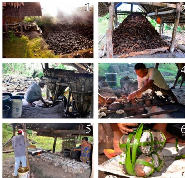
Hình 8. Quy trình sản xuất muối của cư dân tại Alburquerque, đảo Bohol, Philippines
